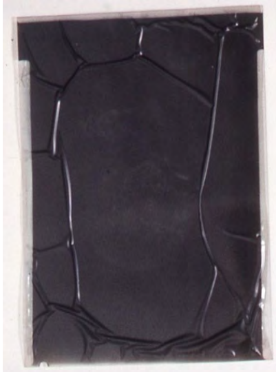
Bild 34. Acetatnegativ under nedbrytning – emulsionssidan.
