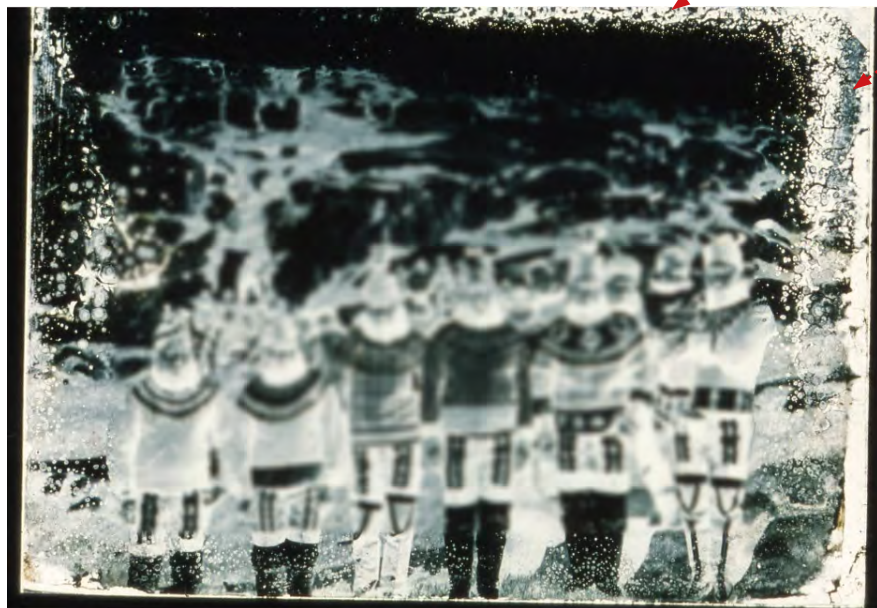
Blid 27. Silvergelatinsglasnegativ med spår efter mögelangrepp (se pilar) där emulsionen delvis lösts upp – gelatinemulsion som utsätts för mögelangrepp förlorar sin hållbarhet i fukt eller väta.
