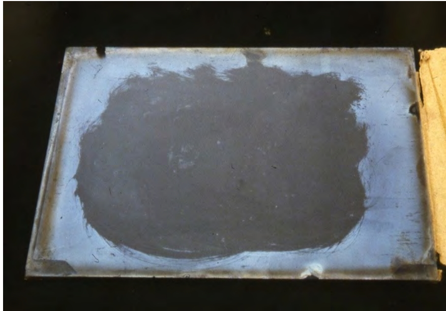
Bild 26. Silvergelatinsplåt med silverspeglingslängs kanterna – formen på silverspeglingen indikerar att den mörka delen av bilden preparerats med något för att uppnå en medveten effekt, som t.ex. en uppmjukning, ”softning”, av bilden.
