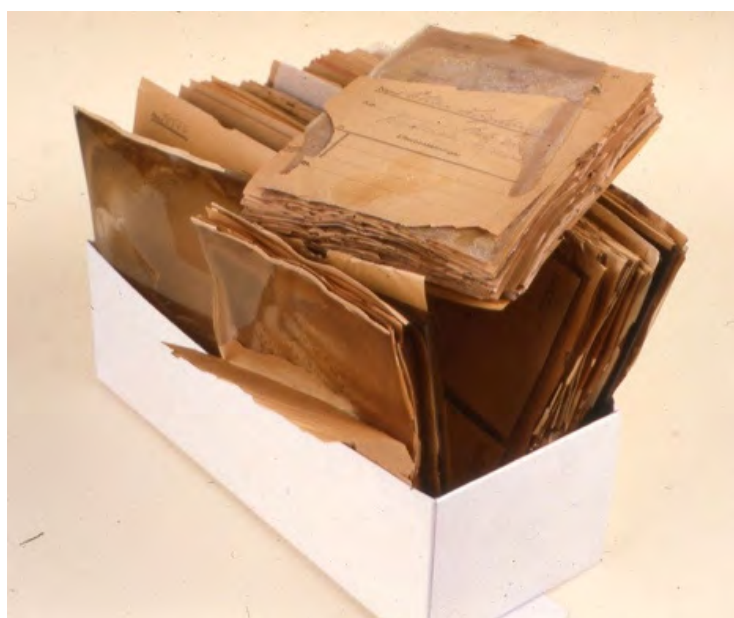
Bild 32. Sammanklibbade nedbrutna nitratnegativ.
