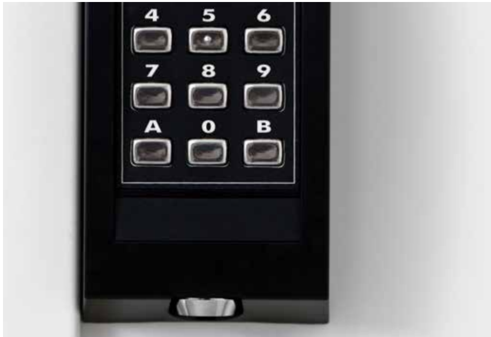
Bild 2. Inpassering med två-faktoridentifikation, tagg och sifferkod.
