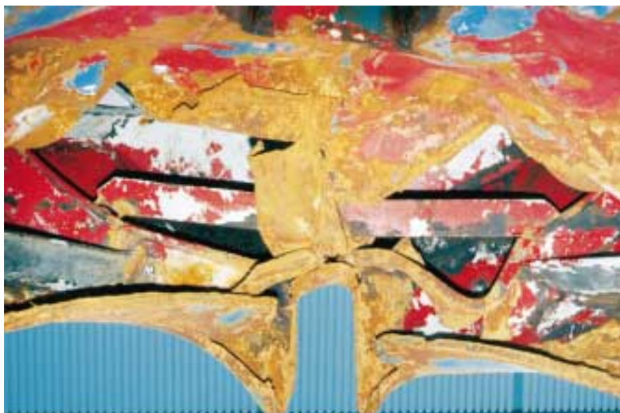
Figur 8.6 Skador på visirets bottenkonstruktion.
