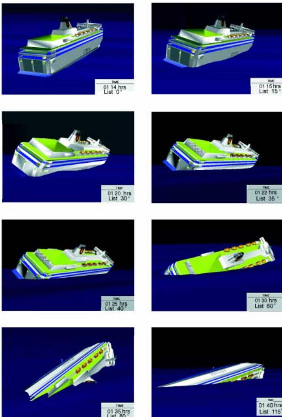
Figur 13.3 Datoranimerade bilder som visar slagsidans utveckling och fartygets förlisning. Ungefärliga tidpunkter och slagsida i grader är angivna i nedre högra hörnet av varje bild.
