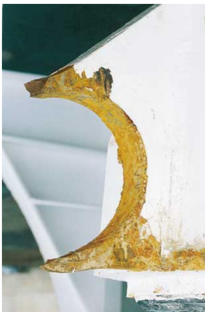
Figur 8.22 Brustet babordsöra till visirgångjärn på babordssidan.
