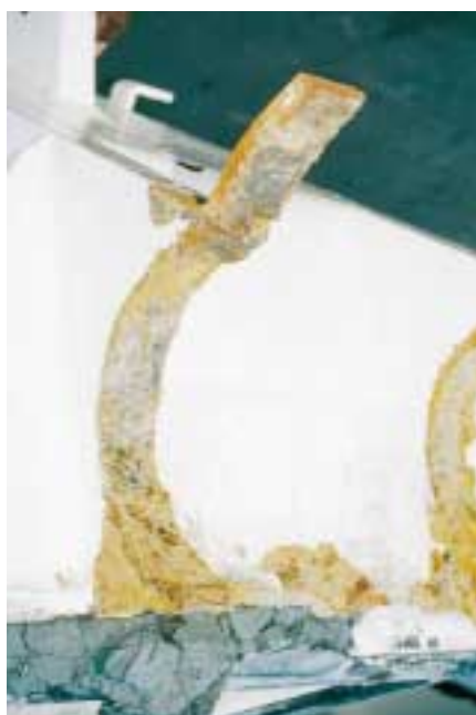
Figur 8.23 Brustet babordsöra till visirgångjärn på styrbordssidan.
