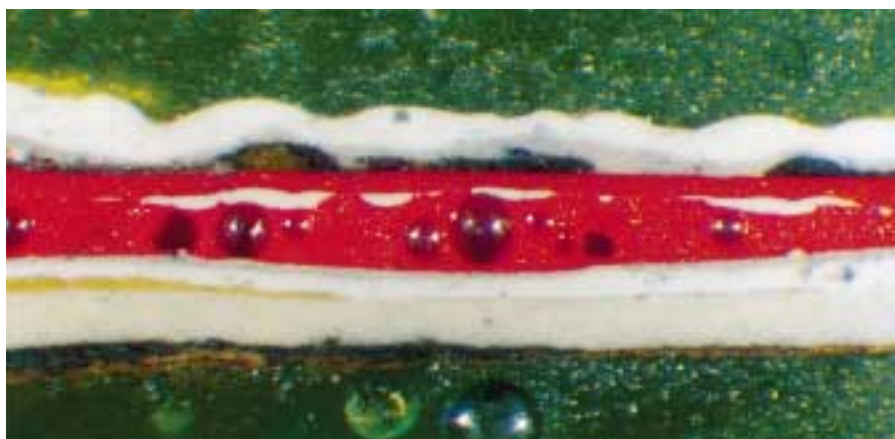
Figur 12.20 Tvärsnitt av färgprov från visirörat till bottenlåset.
