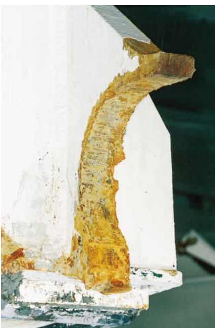
Figur 8.24 Brustet styrbordsöra till gångjärn på styrbordssidan.
