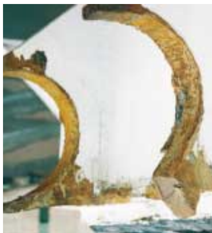
Figur 8.21 Brustna visirgångjärnsöron på babordssidan.
