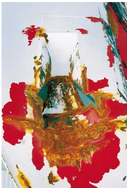
..... Figur 8.8 Skador på försänkningen för babordssidans styrkona.
